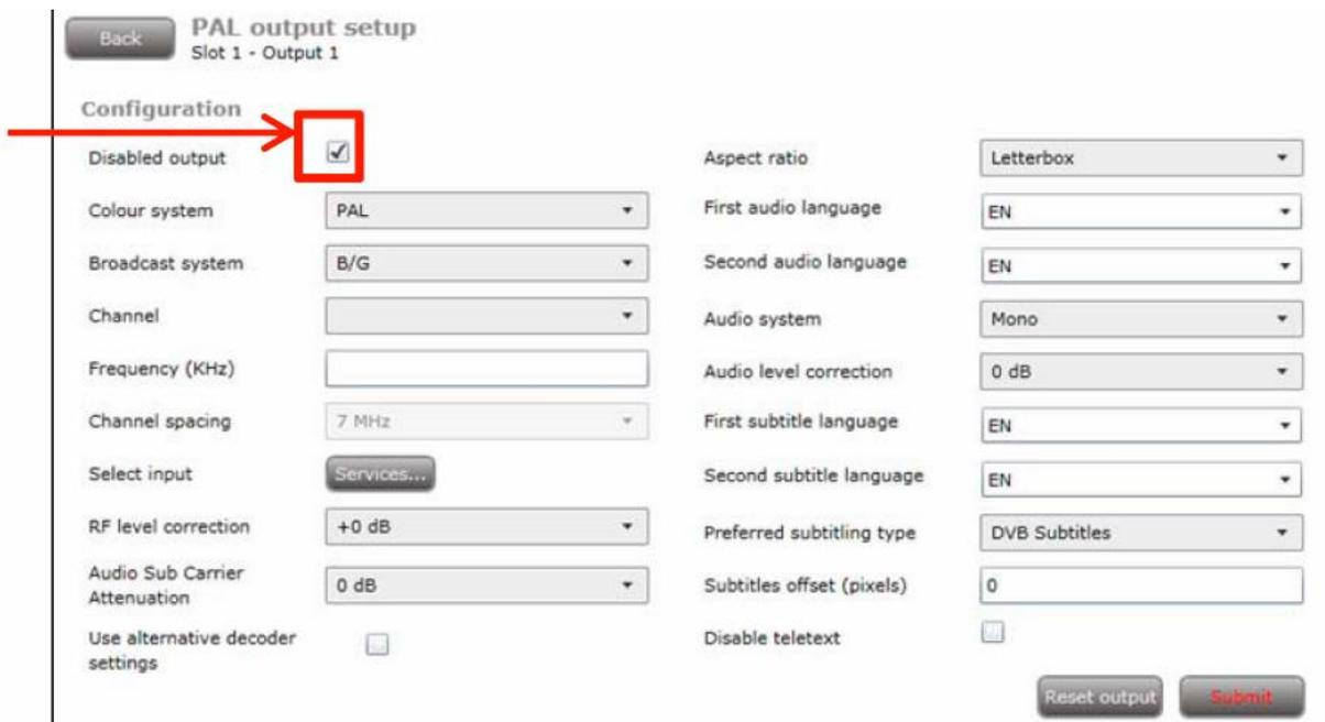
В меню настройки модуля можно установить так же выходной уровень сигнала, формат экрана, формат звука, уровень аудио сигнала, язык вещания, субтитры и т.д.
