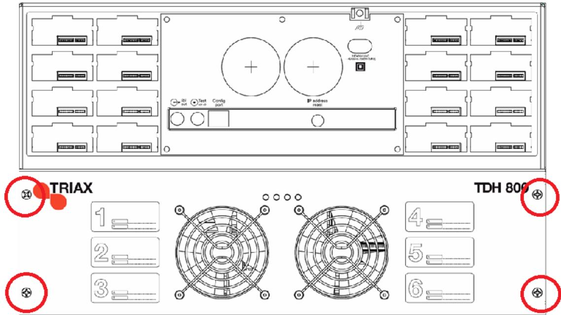
Для установки модуля нужно отключить питание головной станции, открутить 4 винта, как показано на рисунке выше, и снять нижнюю переднюю крышку. Выбрать любой свободный слот и установить в него модуль до срабатывания фиксатора.
